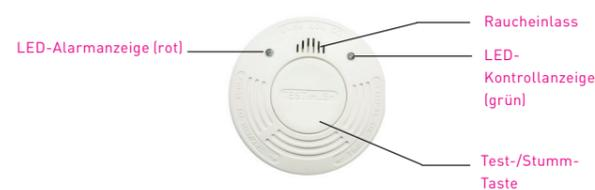
Der Rauchmelder schlägt bei ordnungsgemäßer Anbringung und Nutzung bereits in einer frühen Brandphase Alarm, sobald Brandrauch erkannt wird. Der Melder erkennt nicht Hitze, Gas oder Feuer und kann diese weder verhindern, noch löschen.
